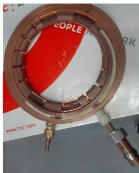
b) Elettrodo assemblato con tagli sulla sezione esterna per lavorazioni
