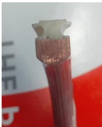
a) sezione coil interno e resina isolante
